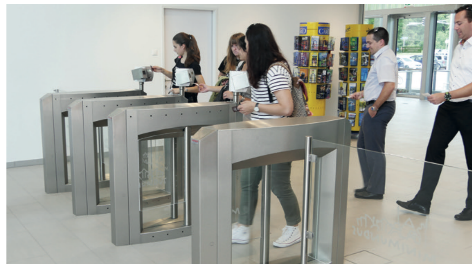
Durch die Zutrittsschleusen Selection DF wird im Eingangsbereich eine hohe Durchgangsfrequenz ermöglicht und eine sichere Personenvereinzlung gewährleistet.
